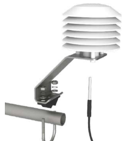
Figura 9 Installazione di una sonda di temperatura 107 e di uno schermo di radiazione su un braccio trasversale
