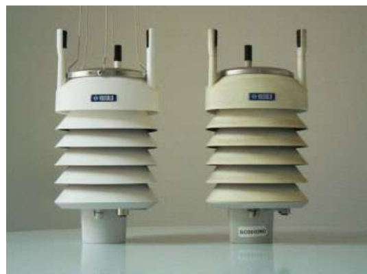
Figura 20 Fotografia di due WXT520. A sinistra WXT520 dopo 1 anno, a destra WXT520 dopo 3 anni.
