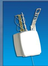
➢ Le sonde attualmente utilizzate sono sonde Vaisala RS92-SG. Dal 1994 (anno in cui si è cominciata l'attività di radiosondaggio a L'Aquila) si sono utilizzate tre tipologie di sonde: la RS80, la RS92 attualmente in dotazione che presto sarà sostituita dalla RS41.
